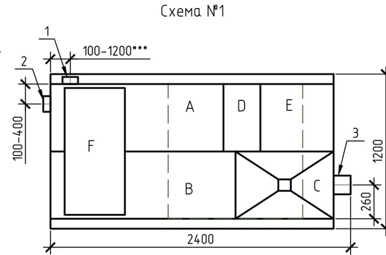
Габаритные размеры ТОПАЭРО 3 + нарост 0,2 м\*\*:
